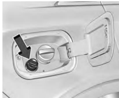
Il tappo blu AdBlue si trova dietro allo sportello carburante/AdBlue. Se dotato di tappo carburante, non rimuovere i tappi carburante e AdBlue allo stesso tempo. Rabboccare AdBlue e diesel separatamente. Girare il tappo AdBlue in senso antiorario per toglierlo.
