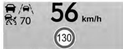
**Vista velocità** : Questo visualizza la velocità digitalmente nell'unità di misura metrica o inglese, il limite di velocità e gli indicatori come quello per il veicolo che precede, l'ausilio al mantenimento di corsia/ scostamento dalla corsia e il Cruise control adattivo e permette di impostare la velocità. Alcune informazioni compaiono solo sui veicoli dotati di queste funzioni e con tali funzioni attive.
