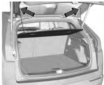
Se in dotazione, la copertura del carico può essere usata per coprire gli oggetti che si trovano nel vano di carico.
