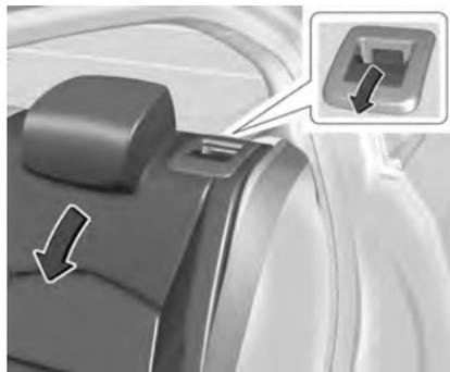
3. Tirare la leva sulla parte alta dello schienale per sbloccarlo e ripiegare lo schienale in avanti.
