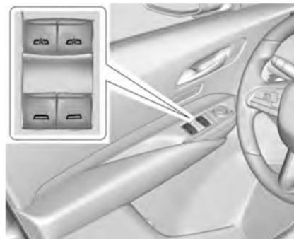
I finestrini elettrici funzionano quando l'accensione è inserita, in posizione accessori oppure quando il mantenimento della corrente per gli accessori (RAP) è attivo. Vedere *Funzione di mantenimento dell'alimentazione elettrica degli accessori (RAP)* ⇨ 207.
