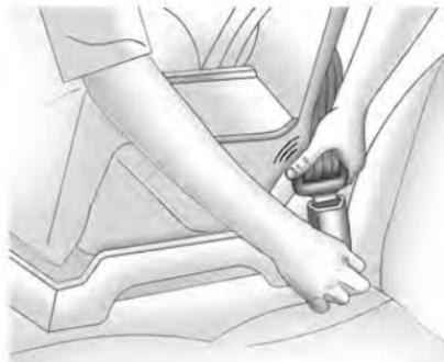
3. Inserire la linguetta di chiusura nella fibbia fino a quando non scatta in posizione. Posizionare il pulsante di sblocco sulla fibbia, lontano dal sistema di sicurezza per bambini, in modo che, se necessario, la cintura di sicurezza possa essere slacciata velocemente. Non deve esserci contatto diretto tra sistema di sicurezza per bambini e pulsante.
