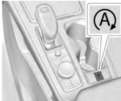
La funzione di Stop/Start automatico del motore può essere disabilitata e abilitata premendo (A). La funzione Stop/Start automatica viene abilitata ad ogni avvio del veicolo.
