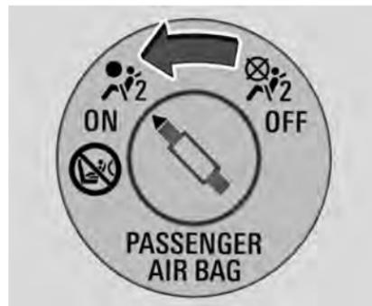
Per riattivare l'airbag frontale del passeggero anteriore esterno, inserire la chiave di accensione nell'interruttore di disattivazione degli airbag, spingerla verso l'interno e ruotare l'interruttore in posizione ON.
