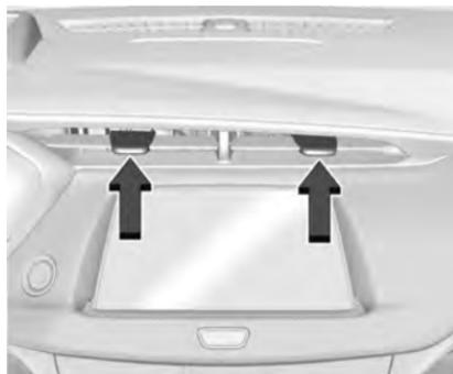
Bocchette di ventilazione orientabili sono poste al centro e ai lati del pannello strumenti, e nella parte posteriore del portaoggetti della consolle centrale.
