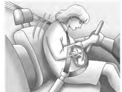
Una donna in gravidanza deve indossare una cintura di sicurezza a tre punti di ancoraggio posizionando la fascia addominale più in basso possibile, sotto l'addome.
