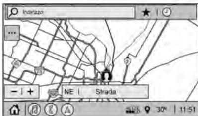
Dopo aver aperto l'applicazione Nav per la prima volta, l'applicazione inizia sempre con la visualizzazione della mappa intera con la posizione corrente del veicolo. Quando il veicolo si arresta, appare la barra di ricerca lungo il bordo superiore della mappa di navigazione. Si può chiudere manualmente
