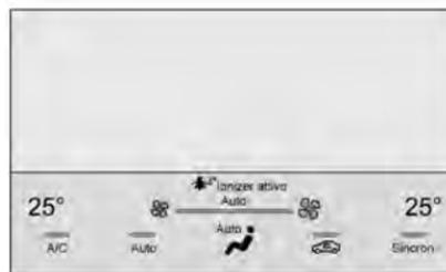
La visualizzazione dello stato di controllo del climatizzatore appare brevemente si regolano i relativi comandi.
