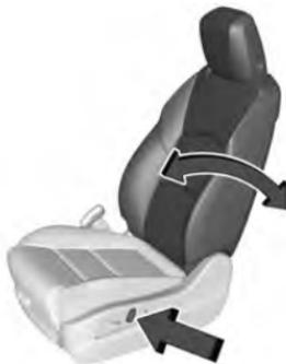
Per regolare lo schienale del sedile elettrico, se in dotazione:
