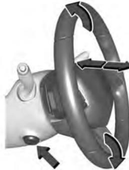
Premere il comando per spostare il volante a regolazione telescopica e dell'inclinazione in senso verticale o orizzontale.
