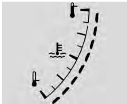
Questo indicatore misura la temperatura del motore del veicolo.
