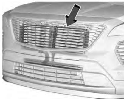
Il veicolo può essere dotato di un sistema otturatore ideato per aiutare a migliorare il consumo di carburante. Mantenere il sistema otturatore libero da detriti, neve e ghiaccio. Se la spia di controllo motore si accende, verificare che il sistema otturatore sia privo di detriti, neve o ghiaccio.
