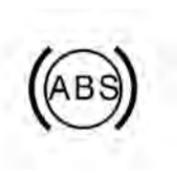
Se c'è un problema con l'ABS, la spia rimarrà accesa. Vedere *Spia del sistema di antibloccaggio (ABS)* ⇨ 113.
