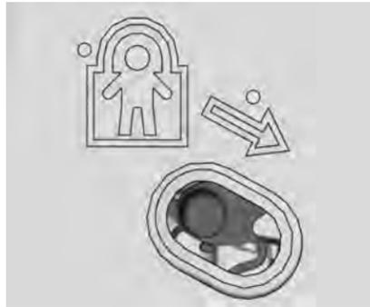
La sicura per bambini si trova sul bordo interno delle portiere posteriori. Per usare il blocco di sicurezza:
