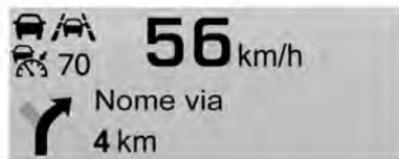
**Vista navigazione** : Questo visualizza la velocità digitale, gli indicatori dalla vista velocità insieme con le informazioni della navigazione passo-passo in alcuni veicoli. Quando l'itinerario di navigazione non è attivo è visualizzata la bussola.
