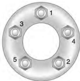
14. Serrare i dadi ruota saldamente in sequenza incrociata, come mostrato in figura.
