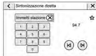
Accedere a Sintonizzazione diretta toccando l'icona Sinton. sul display del sistema di Infotainment così da visualizzare il tastierino. Far passare tutte le frequenze usando le frecce a destra del display di sintonizzazione diretta. Sintonizzarsi direttamente su una stazione usando la tastiera. Quando viene inserita una nuova stazione, le informazioni
