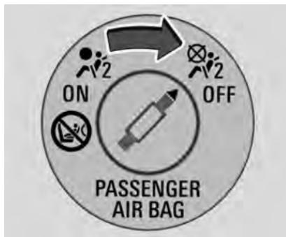
Per disattivare l'airbag frontale del passeggero anteriore esterno, inserire la chiave di accensione nell'interruttore di disattivazione degli airbag, spingerla verso l'interno e ruotare l'interruttore in posizione OFF.
