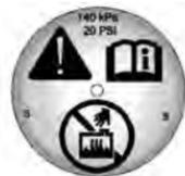
1. Ruotare lentamente il tappo a pressione in senso antiorario. Se viene emesso un sibilo, continuare a girare fino a fine corsa. Un sibilo indica che è ancora presente pressione.
