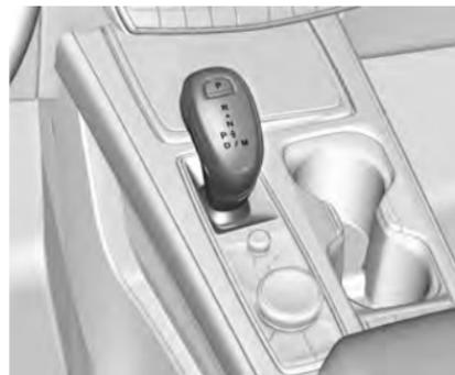
Lo schema di selezione del cambio è mostrato sulla parte superiore della leva selettoria. La posizione di marcia selezionata si accende di rosso sulla leva del cambio
