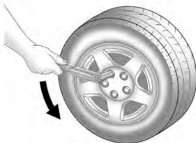
3. Girare la chiave per ruota in senso antiorario per allentare tutti i bulloni della ruota, ma non rimuoverli adesso.
