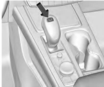
**P** : Questa posizione blocca le ruote motrici. Usare P (Park) durante l'avvio del motore per impedire al veicolo di muoversi con facilità.
