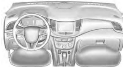
L'airbag per le ginocchia del conducente è dietro al piantone dello sterzo. L'airbag per le ginocchia del passeggero esterno è sotto il cassettino portaoggetti.
