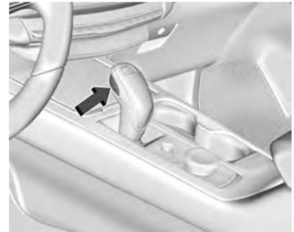
Questo veicolo è dotato di trasmissione a controllo elettronico. Il pulsante di sblocco della leva del cambio è progettato per impedire una fuoriuscita accidentale dalla posizione di P (Parcheggio) a meno che l'accensione non sia inserita, il pedale del
