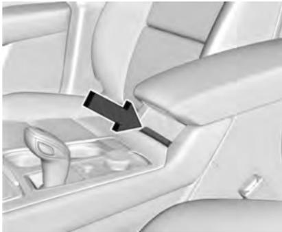
Nella parte anteriore del portaoggetti della console è sistemato un caricatore wireless per smartphone. Vedere *Sistema di ricarica wireless* ⇨ 100.
