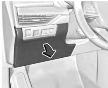
La scatola portafusibili nel quadro strumenti è montata sul lato conducente del cruscotto tra il volante e la portiera. Per accedere ai fusibili, rimuovere il pannello, partendo dalla parte superiore. Dopo aver disinserito i fermagli, e possibile disinserire le linguette lungo la parte inferiore dello sportello dal cruscotto per togliere lo sportello.
