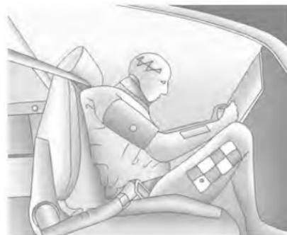
Quando viaggiano a bordo di un veicolo, i passeggeri hanno la stessa velocità del veicolo stesso. Se il veicolo si ferma improvvisamente, i passeggeri continuano il movimento fino a quando qualcosa non li ferma. Potrebbero essere il parabrezza, il cruscotto o le cinture di sicurezza!
