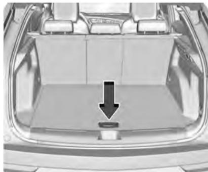
Sul pavimento, nella parte posteriore del vano di carico, è presente un vano portaoggetti. Sollevare la maniglia per aprire.
