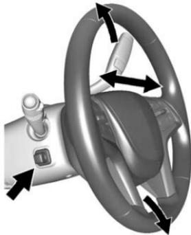
Per regolare il volante telescopico e inclinabile elettrico:
