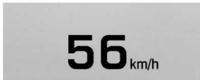
**Vista velocità :** Questo display mostra la lettura del tachimetro (in unità inglesi o metriche), il limite di velocità, la velocità del Cruise control adattivo, l'avvisatore di cambio accidentale della corsia di marcia e l'indicatore di veicolo che precede. Alcune informazioni compaiono solo sui veicoli dotati di queste funzioni e con tali funzioni attive.
