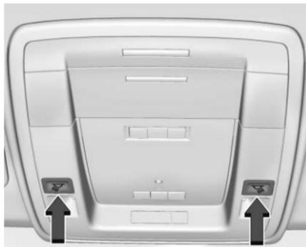
Se in dotazione, ci sono luci di lettura nella console superiore e nel rivestimento del padiglione. Per l'azionamento, l'accensione deve trovarsi in posizione ON o ACC/ACCESSORY oppure dev'essere attiva la modalità di mantenimento della corrente per gli accessori (RAP).
