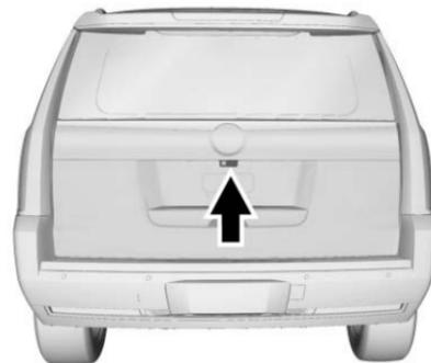
La telecamera che fornisce l'immagine della videocamera posteriore (RCM) è posizionata sopra la targa, accanto alla videocamera posteriore (RVC).
