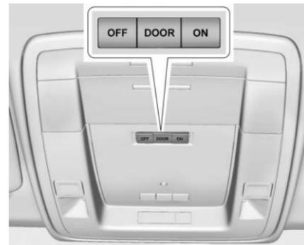
Se in dotazione, ci sono due luci plafoniere, nella console superiore e nel rivestimento del padiglione.
