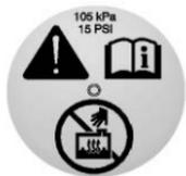
1. Togliere il tappo a pressione del vaso di espansione del liquido di raffreddamento quando l'impianto di raffreddamento, incluso il tappo a pressione del vaso di espansione del liquido di raffreddamento e il tubo flessibile del radiatore superiore, non sono più bollenti.
