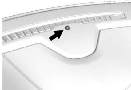
Sulla parte superiore del quadro strumenti, è montato il sensore di luce che gestisce l'impianto fari automatico. Non coprire il sensore, altrimenti i fari potrebbero accendersi quando non è necessario.
