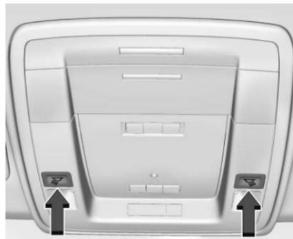
Se presenti, la console superiore e il rivestimento interno del padiglione sono dotati di luci di lettura. Per attivarle, l'accensione deve essere inserita o in posizione ACC/ACCESSORY oppure la modalità di mantenimento della corrente per gli accessori (RAP) dev'essere attiva.
