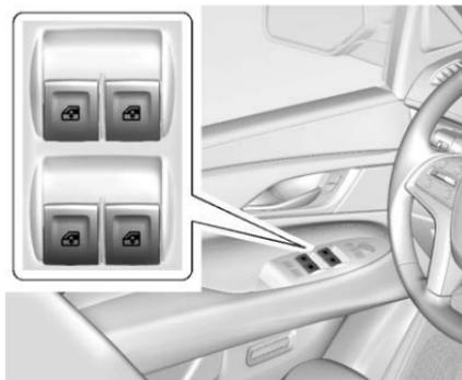
I finestrini elettrici funzionano quando l'accensione è inserita, in posizione ACC/ACCESSORY oppure quando il mantenimento della corrente per gli accessori (RAP) è attivo. Vedere *Potenza Accessorio a Ritenuta (RAP)* ⇨ 230.
