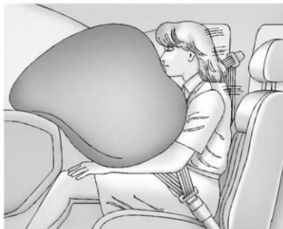
L'airbag anteriore del passeggero anteriore esterno si trova nel quadro strumenti del passeggero.
