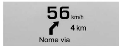
**Vista navigazione :** Questo display visualizza le informazioni della vista velocità insieme con le informazioni di navigazione passo-passo. Quando l'itinerario di navigazione non è attivo è visualizzata la bussola.
