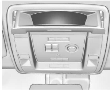
Se in dotazione, lo specchietto controlla bimbo sulla console superiore. Premere il pulsante fisso sulla copertura per sganciare. Rialzare lo specchietto quando non è utilizzato.
