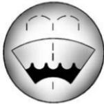
Aprire il tappo che riporta il simbolo lavavetri. Aggiungere liquido lavavetri fino a riempire il serbatoio. Per la posizione del serbatoio, vedere *Panoramica vano motore* ⇨ 305.
