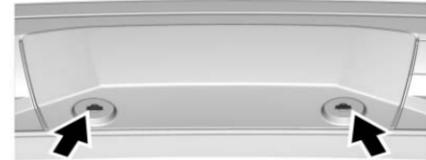
Se dotato di coperchio, ruotare i fermi del coperchio dell'attacco in senso antiorario e tirare il coperchio verso il basso per estrarlo prima di rimuovere lo sportello di accesso all'albero sollevatore.
