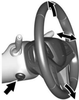
Premere il comando per spostare il volante a regolazione telescopica e dell'inclinazione verso l'alto e il basso oppure in avanti o all'indietro.
