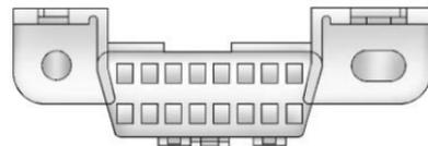
Il DLC si trova sotto il cruscotto a sinistra del volante. Il collegamento di dispositivi non utilizzati per il controllo anti-emissioni/prova manutenzione o per finalità assistenziali, possono compromettere il buon funzionamento del veicolo. Vedere *Componenti elettriche non originali* ⇨ 268. Consultate il vostro concessionario se necessitate assistenza.
