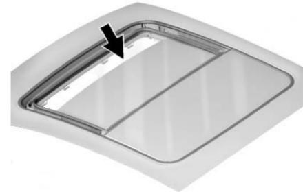
È possibile che sporcizia e altre impurità possano accumularsi nella guida o nella guarnizione del tettuccio apribile. Ciò potrebbe causare un
