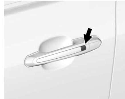
Premere il pulsante sulla maniglia della portiera e tirare la maniglia quando il telecomando del sistema di ingresso senza chiave remoto (RKE) si trova nel raggio d'azione. Vedere *Apertura con telecomando a distanza (RKE) funzionamento sistema* ⇨ 29.
