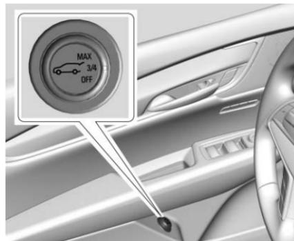
L'interruttore del portellone elettrico si trova sulla portiera del conducente. Il veicolo deve essere in P (parcheggio).
