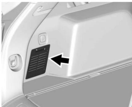
La scatola portafusibili nel vano di carico del bagagliaio, sul lato conducente, dietro il pannello di
