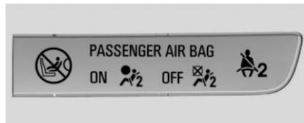
Il sistema di rilevamento del passeggero disattiva l'airbag frontale del passeggero esterno anteriore, in alcune condizioni. Nessun altro airbag è interessato dal sistema di rilevamento del passeggero. Vedere *Sistema di rilevamento del passeggero* ⇨ 84.
