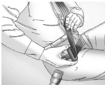
Se la cintura si blocca nella linguetta di chiusura prima di raggiungere la fibbia, oscillare la linguetta in modo che sia dritta per sbloccare la cintura.
