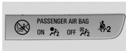
All'avviamento del veicolo, come controllo di sistema, l'indicatore di stato dell'airbag lato passeggero illuminerà i simboli di "acceso" e "spento" per alcuni secondi. Successivamente, dopo alcuni secondi, sull'indicatore di stato si illuminano i simboli di "acceso" o "spento", in modo da indicare il reale stato dell'airbag frontale del passeggero anteriore esterno.
