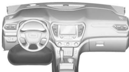
L'airbag per le ginocchia del conducente è dietro al piantone dello sterzo.
