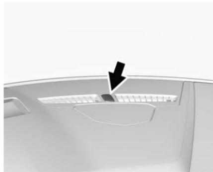
Un sensore di luce è ubicato sulla parte superiore del quadro strumenti. Non coprire il sensore.
