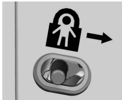
Se presente, la sicura per bambini si trova sul bordo interno delle portiere posteriori. Per usare il blocco di sicurezza:
