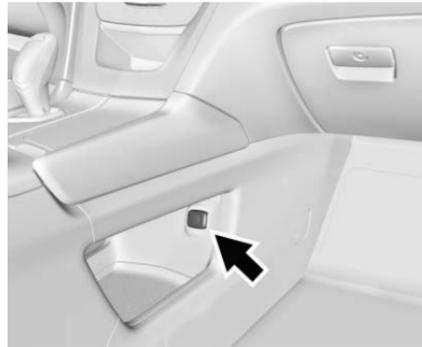
Il veicolo ha due prese di corrente accessorie, una nella console inferiore centrale del pavimento e una nell'area posteriore di carico.
