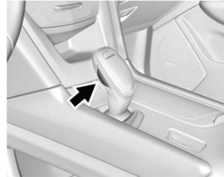
Questo veicolo è dotato di trasmissione elettronica. Il pulsante di sblocco della leva di selezione marce è progettato per impedire una fuoriuscita accidentale dalla posizione di P (Parcheggio) a meno che l'accensione non sia su ON/RUN (On/Marcia), il pedale del freno non sia premuto e il pulsante di sblocco della leva di selezione non sia premuto.
