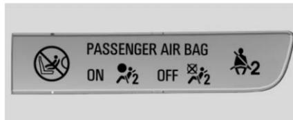
L'icona di sistema attivo e disattivo è visibile durante la verifica del sistema. Quando il controllo del sistema è completato, sarà visibile il simbolo di attivazione o di disattivazione. Vedere *Indicatore di stato airbag passeggero* ⇨ 136.
