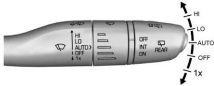
Tergicristalli del parabrezza con Rainsense (AUTO illustrato), se in dotazione
