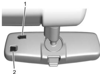
Per regolare la luminosità, premere il pulsante (1) sul retro dello specchietto retrovisore senza coprire il sensore di luminosità (2).
