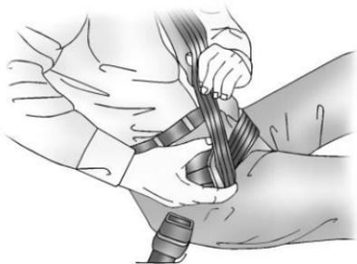
Se la cintura si blocca nella linguetta di chiusura prima di raggiungere la fibbia, oscillare la linguetta in modo che sia diritta per sbloccare la cintura.
