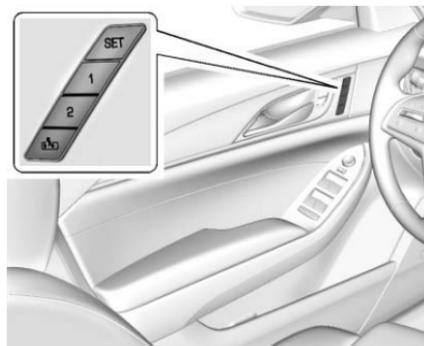
Se in dotazione, i pulsanti SET, 1, 2 e
