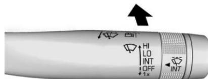
Se presente, spingere la leva del tergicristalli in avanti per nebulizzare liquido di lavaggio sullo specchietto della videocamera. Al rilascio la leva ritorna autonomamente alla posizione iniziale. Vedere *Retrocamera specchietto* ⇨ 50.
