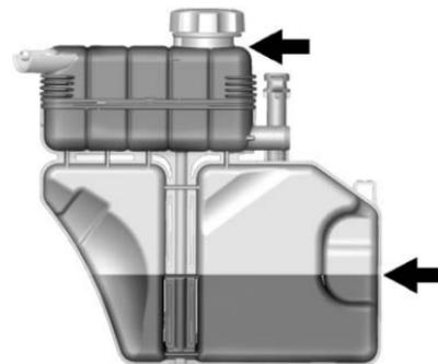
3. Riempire la sezione superiore del vaso d'espansione con la miscela corretta di liquido di raffreddamento DEX-COOL fino alla base del collare di riempimento. La sezione superiore deve essere completamente piena. Riempire la sezione inferiore del vaso d'espansione attraverso la porta di manutenzione di circa la metà.
