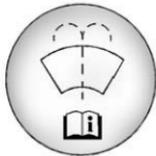
Aprire il tappo che riporta il simbolo lavavetri. Aggiungere liquido lavavetri fino a riempire il serbatoio. Per la posizione del serbatoio, vedere *Panoramica vano motore* ⇨ 284.
