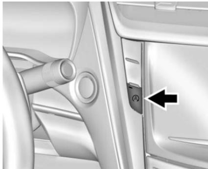
La funzione automatica di avvio/arresto del motore può essere disattivata usando l'interruttore sul
