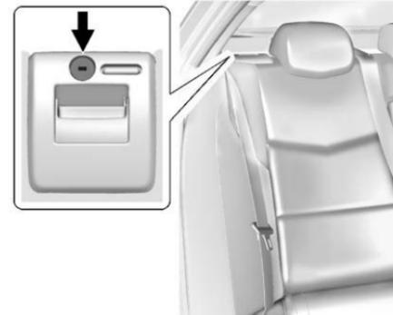
I sedili abbattibili sdoppiabili sono dotati di serratura di bloccaggio.
