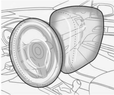
L'airbag frontale del conducente si trova al centro del volante.
