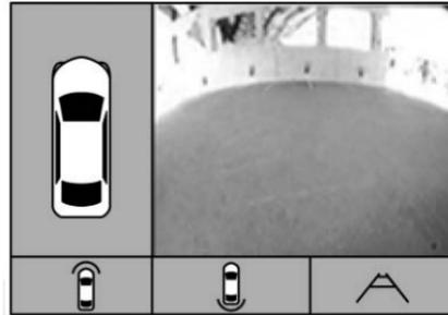
Se presente, l'area davanti al veicolo viene visualizzata nella consolle centrale. La visualizzazione inizia dopo aver portato il cambio da R (Retromarcia) in una marcia avanti, o premendo CAMERA nella consolle centrale, e quando il veicolo si sposta in avanti con velocità inferiore a 8 km/h (5 mph). Se presente, la videocamera vista anteriore riprende anche quando il Sistema di ausilio al parcheggio rileva un oggetto entro un raggio di 30 cm (12 pollici).
