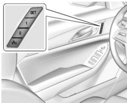
I pulsanti SET, 1, 2 e
