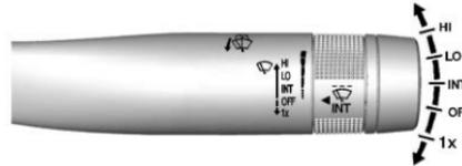
Con l'accensione del veicolo in posizione ACC/ACCESSORY o ON/RUN/START, spostare la leva del tergicristallo per selezionare la velocità del tergicristallo.
