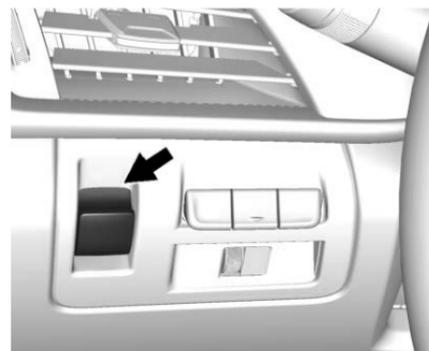
Il veicolo è dotato di Freno elettrico di stazionamento (Electronic Parking Brake, EPB). L'interruttore per l'EPB SI trova sul quadro strumenti alla sinistra dello sterzo. L'EPB può sempre essere attivato, anche a quadro spento. Per evitare il consumo della batteria, evitare di ripetere i cicli del sistema EPB quando il motore non è in funzione.
