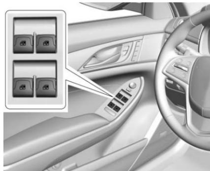
Gli interruttori dell'alzacristalli elettrico del conducente controllano tutti i finestrini. L'interruttore del passeggero controlla solo il relativo finestrino.
