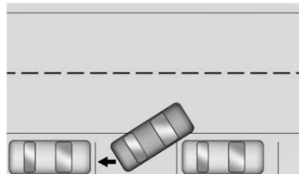
Il sistema APA impartirà al veicolo il comando di arrestarsi non appena viene rilevato una zona sufficientemente grande per il parcheggio. Seguire le istruzioni visualizzate sul DIC. Quando indicato di procedere in retromarcia, innestare la R (retromarcia) per inserire lo sterzo automatico. Il volante vibrerà per un breve attimo per ricordare al conducente di allontanare le mani. Controllare i dintorni e continuare a frenare o ad accelerare secondo necessità, quindi tenersi pronti ad
