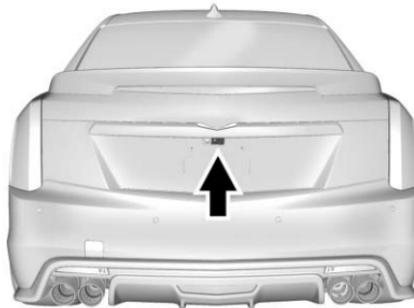
La telecamera che fornisce l'immagine della videocamera posteriore (RCM) è posizionata sopra la targa, accanto alla videocamera posteriore (RVC).
