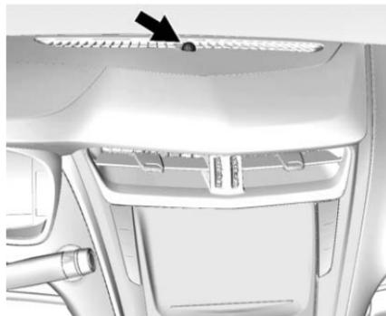
Se presente, il sensore luce si trova nella parte superiore del cruscotto o sul parabrezza accanto allo specchietto retrovisore. Non coprire il sensore. Altrimenti i fari si accenderanno quando non necessario.
