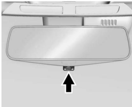
Tirare la linguetta all'indietro per azionare il display. Spingere la linguetta in avanti per disattivare. Quando disattivato, lo specchietto è in oscuramento automatico. Regolare lo specchietto per una visuale chiara dell'area retrostante al veicolo con display disattivato.
