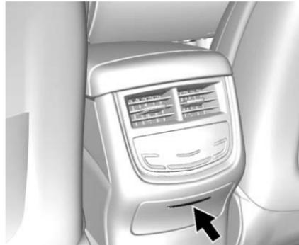
Se presente, premere la parte superiore dello sportello per aprire il vano portaoggetti posto sul retro della console centrale. Se presente, all'interno si trova una presa di corrente.
