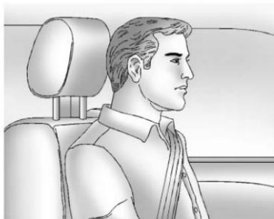
In presenza di sedili di base, regolare il poggiatesta in modo che la sua sommità sia alla stessa altezza della parte superiore della testa degli occupanti. Questa posizione riduce la possibilità di lesioni al collo in caso di incidente.
