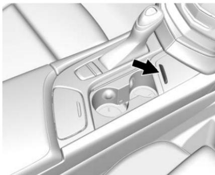
I portabicchieri posti nella console centrale anteriore sono dotati di coperchio apribile elettricamente. Spingere la maniglia in avanti per effettuare l'apertura rapida. Tirare la maniglia all'indietro per effettuare la chiusura rapida.
