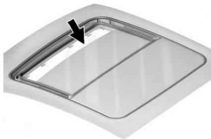
È possibile che sporcizia e altre impurità possano accumularsi nel guida o nella guarnizione del tettuccio apribile. Ciò potrebbe causare un problema con il funzionamento del tetto o il rumore. Potrebbe anche otturare il sistema di drenaggio dell'acqua. Aprire periodicamente il tettuccio e rimuovere tutti gli ostacoli o i residui sciolti. Pulire la tenuta del tettuccio e l'area di tenuta del tetto usando un panno pulito, sapone delicato e acqua. Non rimuovere il grasso dal tettuccio apribile.
