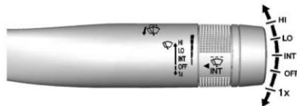
Con l'accensione del veicolo in posizione ACC/ACCESSORY o ON/RUN/STRT, spostare la leva per selezionare la velocità dei tergicristalli.
