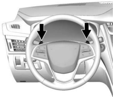
I veicoli dotati di cambio scalare presentano i comandi con cui cambiare manualmente i rapporti del cambio automatico sul retro del volante.
