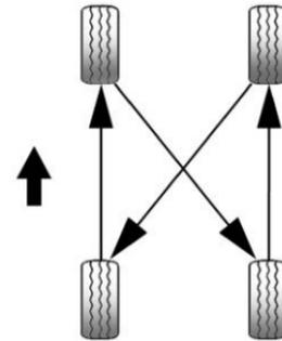
Usare questo modello di rotazione quando si ruotano gli pneumatici di uguali dimensioni montati su tutte le quattro ruote.
