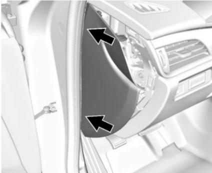
Per montare il coperchio inserire le linguette sul retro del coperchio nelle fessure del cruscotto nei punti mostrati. Allineare i fermagli con le fessure nel cruscotto e premere il coperchio in sede.
