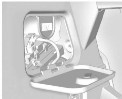
La scatola portafusibili del vano posteriore si trova dietro un coperchio sul lato conducente del vano posteriore.
