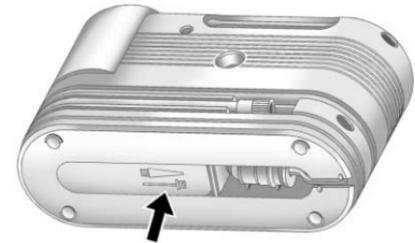
Il kit compressore e sigillante è dotato di un adattatore accessorio posizionato in un compartimento sul fondo del relativo alloggiamento che può essere utilizzato per gonfiare materassini ad aria, palloni ecc.
