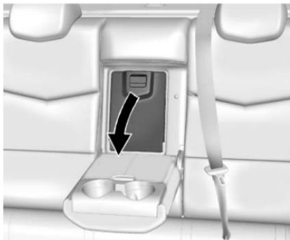
La vettura è dotata, al centro dello schienale posteriore, di uno sportello apribile. Ripiegare in basso il bracciolo centrale e tirare la leva completamente verso il basso per rilasciare la portiera.
