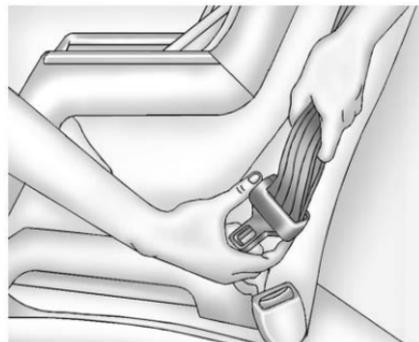
Inclinare la piastra di chiusura per regolare la cintura se necessario.
