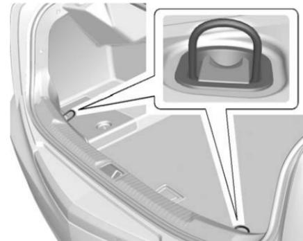
I tiranti del carico possono essere utilizzati per fissare carichi di piccole dimensioni interni al bagagliaio.
