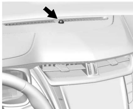
Il sensore solare in cima al cruscotto, vicino al parabrezza, effettua il monitoraggio del calore proveniente dai raggi solari.
