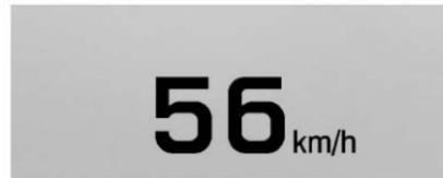
**Vista velocità :** Questo display mostra la lettura del tachimetro (in unità inglesi o metriche), il limite di velocità, la velocità del Cruise control adattivo, l'avvisatore di cambio accidentale della corsia di marcia e l'indicatore di veicolo che precede.
