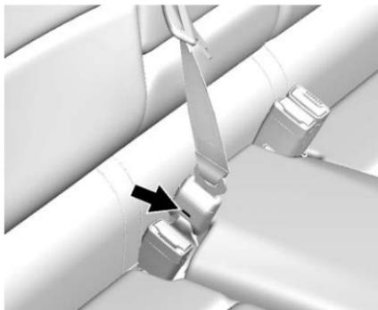
1. Scollegare la mini-chiusura della cintura di sicurezza posteriore usando una chiave nel foro presente sulla mini-fibbia, e lasciare che la cintura si riavvolga.
