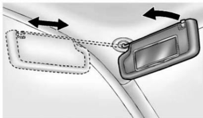
Abbassare le alette parasole per schermare il riflesso. Staccare l'aletta parasole dal punto di montaggio centrale per ruotarla verso il finestrino laterale o, se presente, per estenderla lungo l'asta.
