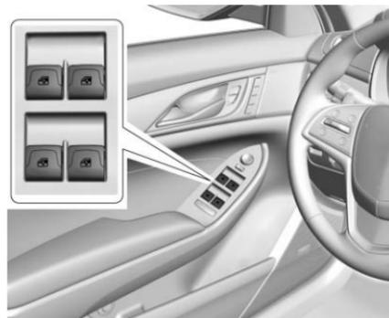
I finestrini funzionano quando il veicolo è in posizione ON/RUN o ACC/ACCESSORY oppure quando il mantenimento della corrente per gli accessori (RAP) è attivo. Vedere *Potenza Accessorio a Ritenuta (RAP)* ⇨ 221.
