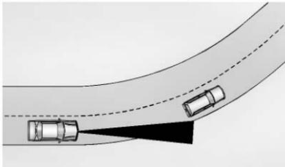
Quando si segue un veicolo e si entra in una curva, l'ACC potrebbe non rilevare il veicolo davanti e accelerare
