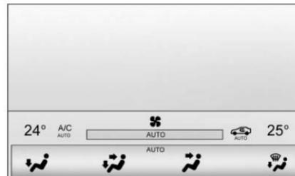
La schermata dello stato del climatizzatore appare per pochi istanti quando si regolano i tasti del climatizzatore sulla maschera. La modalità di erogazione dell'aria può essere regolata sulla schermata dello stato del climatizzatore.
