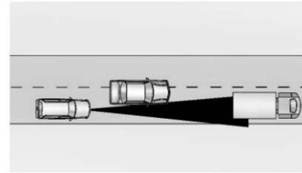
L'ACC non rileverà un veicolo che precede fino a che questo non sia completamente nella corsia. Potrebbe essere necessario applicare manualmente il freno.
