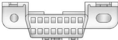
Il DLC si trova sotto il cruscotto a sinistra del volante. Il collegamento di dispositivi non utilizzati per il controllo anti-emissioni/prova manutenzione o per finalità assistenziali, possono compromettere il buon funzionamento del veicolo. Vedere *Componenti elettriche non originali* ⇨ 279. Consultate il vostro concessionario se necessitate assistenza.
