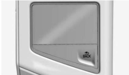
Se in dotazione, il touchpad è integrato nella console centrale del veicolo, di fronte al bracciolo. Fornisce una modalità alternativa di selezionare funzioni sul sistema Infotainment utilizzando un telecomando montato nella console al posto del display Infotainment.
