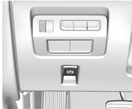
Se dotato di freno di stazionamento elettrico (EPB), l'interruttore si trova a sinistra del quadro strumenti. L'EPB può sempre essere attivato, anche a quadro spento. Per evitare il consumo della batteria, evitare di ripetere i cicli EPB quando il motore non è in funzione.
