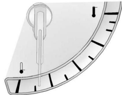
Questo indicatore misura la temperatura del motore del veicolo.
