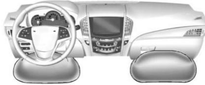
L'airbag per le ginocchia del conducente è dietro al piantone dello sterzo. L'airbag per le ginocchia del passeggero esterno è sotto il cassetto portaoggetti.
