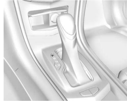
**P** : Questa posizione blocca le ruote posteriori. Utilizzare questa posizione quando si avvia il motore in quanto il veicolo non è in grado di muoversi agevolmente.
