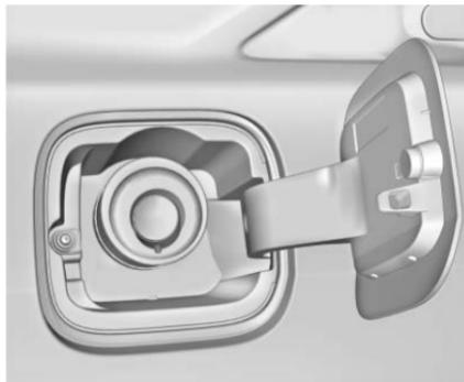
Il veicolo coupè è dotato di sistema di rifornimento senza tappo e, pertanto, è sprovvisto di tappo del carburante. Prima di iniziare il rifornimento, è necessario inserire a fondo la pistola erogatrice e bloccarla.
