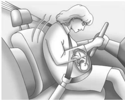
Una donna in gravidanza deve indossare una cintura di sicurezza a tre punti di ancoraggio posizionando la fascia addominale più in basso possibile, sotto l'addome.
