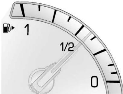
Con l'accensione inserita, l'indicatore del livello di carburante indica la quantità di carburante residuo nel serbatoio.
