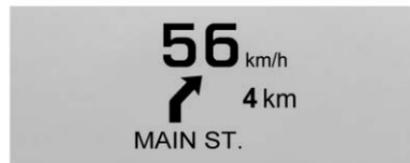
**Vista navigazione :** Questo display comprende le informazioni della vista velocità insieme con le informazioni di navigazione passo-passo. Quando l'itinerario di navigazione non è attivo è visualizzata la bussola.
