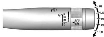
Con l'accensione del veicolo in posizione ACC/ACCESSORY o ON/RUN/STRT, spostare la leva per selezionare la velocità del tergilavacrystallo.
