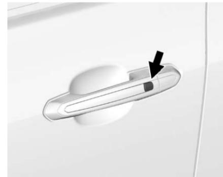
Se presente, usare il sistema di accesso senza chiave per bloccare e sbloccare la portiera. Quando le portiere sono bloccate e il telecomando RKE si trova a una distanza massima di 1 m (3 piedi) dalla maniglia della portiera del
