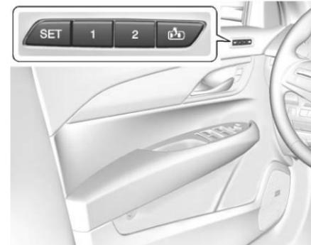
Se in dotazione, i pulsanti 1, 2, SET e
