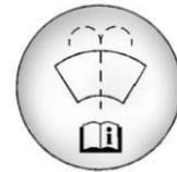
Aprire il tappo che riporta il simbolo lavavetri. Aggiungere liquido lavavetri fino a riempire il serbatoio. Per la posizione del serbatoio, vedere *Panoramica vano motore* ⇨ 276.
