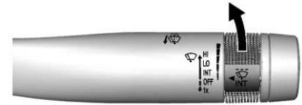
**INT** : Utilizzare questa impostazione per l'intermittenza o per il sistema Rainsense™, se presente. Per la regolazione dell'intermittenza, spostare la leva del tergilavacrystallo su INT. Ruotare la ghiera
