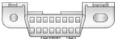
Il DLC si trova sotto il cruscotto a sinistra del volante. Il collegamento di dispositivi non utilizzati per il controllo anti-emissioni/prova manutenzione o per finalità assistenziali, possono compromettere
