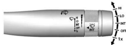
Con l'accensione del veicolo in posizione ACC/ACCESSORY o ON/RUN/START, spostare la leva del tergicristallo per selezionare la velocità del tergicristalli.
