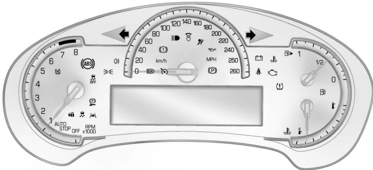
Quadro strumenti con indicazione arresto automatico
