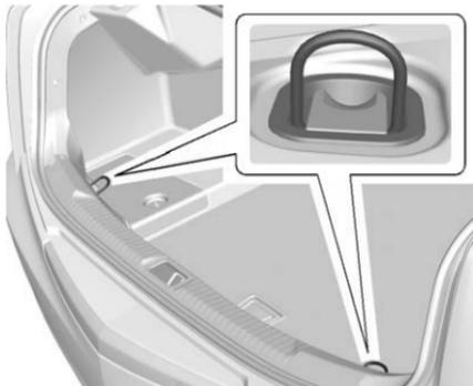
I tiranti del carico possono essere utilizzati per fissare carichi di piccole dimensioni interni al bagagliaio.
