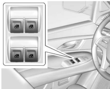
I finestrini funzionano con il veicolo in ON/RUN, ACC/ACCESSORY o quando la modalità di mantenimento della corrente per gli accessori (RAP) è attiva. Vedere *Potenza Accessorio a Ritenuta (RAP)* ⇨ 234.
