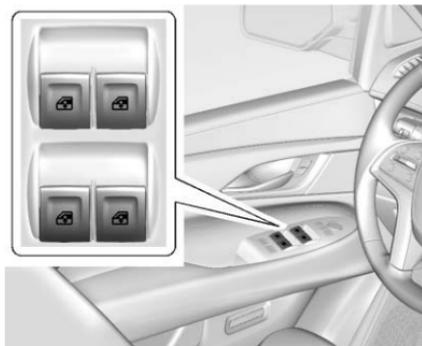
I finestrini funzionano quando il veicolo è in posizione ON/RUN o ACC/ACCESSORY oppure quando il mantenimento della corrente per gli accessori (RAP) è attivo. Vedere *Potenza Accessorio a Ritenuta (RAP)* ⇨ 234.
