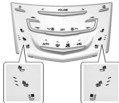
I pulsanti si trovano vicino ai comandi del climatizzatore nella colonnina centrale. Per l'azionamento il motore deve essere in funzione.
