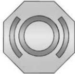
Il serbatoio del cilindro principale dei freni è riempito di liquido dei freni DOT 3 approvato da GM come indicato sul tappo del serbatoio. Vedere *Panoramica vano motore* ⇨ 306 per la posizione del serbatoio.
