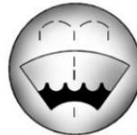
Aprire il tappo che riporta il simbolo lavavetri. Aggiungere liquido lavavetri fino a riempire il serbatoio. Per la posizione del serbatoio, vedere *Panoramica vano motore* ⇨ 306.
