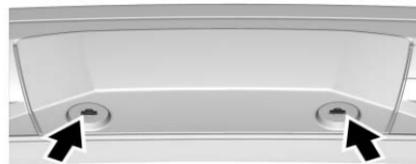
Se dotato di coperchio, ruotare i fermi del coperchio dell'attacco in senso antiorario e tirare il coperchio verso il basso per
