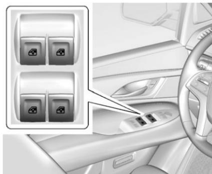
Gli alzacristalli elettrici funzionano con l'accensione in ON/RUN o ACC/ACCESSORY o nella modalità di mantenimento della corrente per gli accessori (RAP). Premere l'interruttore per abbassare il finestrino. Tirare l'interruttore per alzarlo. Vedere *Mantenimento dell'alimentazione per gli accessori (RAP)* ⇨ 240.
