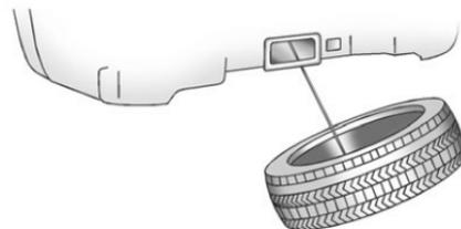
7. Inclinare la ruota verso il veicolo facendo in modo che il cavo non si tenda per accedere al fermo ruota/pneumatico. Inclinare il fermo e tirarlo facendolo passare attraverso il centro della ruota unitamente al cavo e alla molla.
