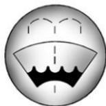
Aprire il tappo che riporta il simbolo lavavetri. Aggiungere liquido lavavetri fino a riempire il serbatoio. Per la posizione del serbatoio, vedere *Panoramica del vano motore* ⇨ 308.
