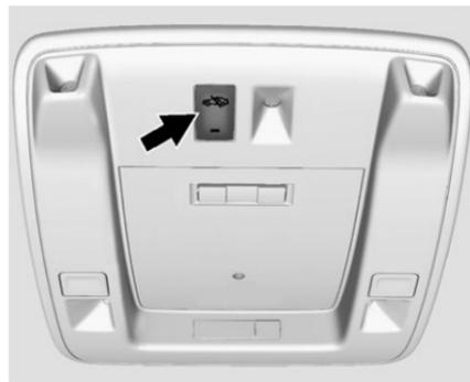
Si raccomanda di disattivare i sensori antintrusione e di inclinazione se vi sono animali all'interno del veicolo o durante il trasporto del veicolo.
