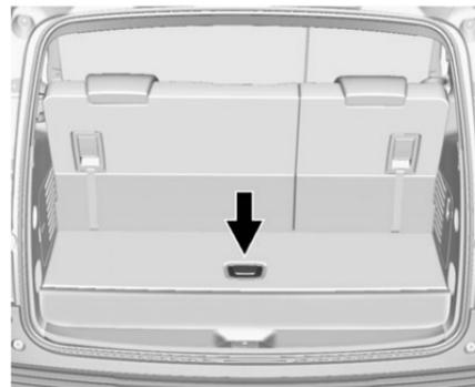
Sul pavimento, nella parte posteriore del vano di carico, è presente un vano portaoggetti.
