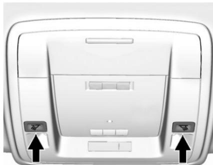
Se presenti, la console superiore e il rivestimento interno del padiglione sono dotati di luci di lettura. Per l'attivazione, l'accensione deve essere in posizione ACC/ACCESSORY o ON/RUN o usare la modalità RAP (mantenimento dell'alimentazione per gli accessori).
