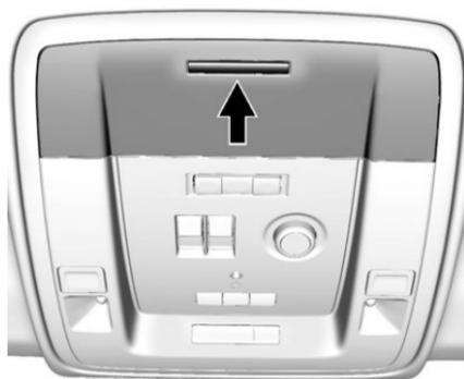
Se presente, il vano portaocchiali si trova sulla console superiore. Premere il pulsante fisso sul coperchio per sbloccare e potervi accedere. All'interno del portaocchiali può esserci uno specchietto per bambini. Sbloccare il portaocchiali e quindi richiuderlo a metà per fissarlo in posizione.
