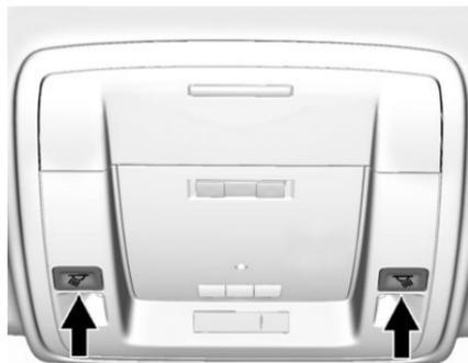
Se in dotazione, ci sono luci di lettura nella console superiore e nel rivestimento del padiglione. Per azionarle, l'accensione deve essere su ACC/ACCESSORY o ON/RUN o utilizzare la modalità RAP (mantenimento dell'alimentazione per gli accessori).
