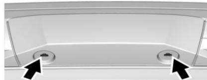
Se dotato di coperchio, ruotare i fermi del coperchio dell'attacco in senso antiorario e tirare il coperchio verso il
