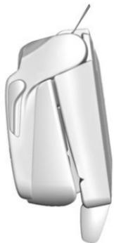
3. Tirare di nuovo la cinghia per sbloccare la parte posteriore del sedile dal pavimento. Il sedile si sposterà in avanti.
