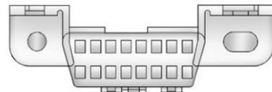
Il DLC si trova sotto il cruscotto a sinistra del volante. Il collegamento di dispositivi non utilizzati per il controllo anti-emissioni/prova manutenzione o per finalità assistenziali, possono compromettere il buon funzionamento del veicolo. A tal fine, vedere *Dispositivi elettrici aggiuntivi* ⇨ 302 Consultate il vostro concessionario se necessitate assistenza.
