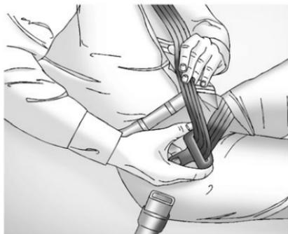
Nei sedili anteriori, se la cintura si blocca nella linguetta di chiusura prima di raggiungere la fibbia, inclinare la linguetta in modo che sia piatta per sbloccare la cintura.
