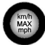
16. Se è stato possibile gonfiare il pneumatico a terra fino alla pressione raccomandata, rimuovere l'etichetta relativa alla velocità massima dal contenitore del sigillante (5) e posizionarla in un punto in cui goda della massima visibilità. Non superare la velocità indicata su questa etichetta fino a quando il pneumatico danneggiato non viene riparato o sostituito.
