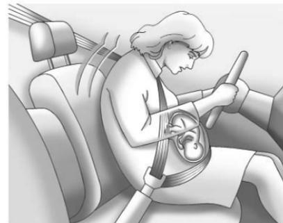
Una donna in gravidanza deve indossare una cintura di sicurezza a tre punti di ancoraggio posizionando la fascia addominale più in basso possibile, sotto l'addome.
