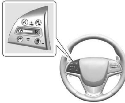
**Ⓞ (On/Off)** : Premere per attivare e disattivare il sistema. Quando il controllo automatico della velocità di crociera è inserito, sul quadro strumenti si accende un indicatore bianco.
