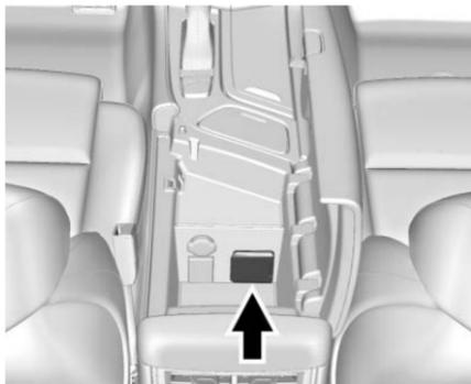
Una spia posta sulla presa si accende quando la presa è in uso. La spia si accende quando l'accensione è su ON/RUN/START, quando alla presa sono collegati dispositivi che richiedono meno di 150 Watt, e non sono rilevati guasti di sistema.
