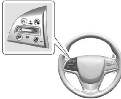
**☺ (On/Off)** : Premere per attivare o disattivare il sistema. Una spia bianca del controllo della velocità di crociera si accende.
