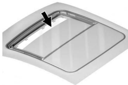
È possibile che sporczia e altre impurità possano accumularsi nel guida o nella guarnizione del tettuccio apribile. Ciò potrebbe causare un problema con il funzionamento del tetto o il rumore.
