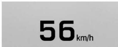
**Vista velocità :** Questo display mostra la lettura del tachimetro (in unità inglesi o metriche), il limite di velocità, l'avvisatore di cambio accidentale della corsia di marcia e l'indicatore di veicolo che precede. Alcune informazioni compaiono solo sui veicoli dotati di queste funzioni e con tali funzioni attive.
