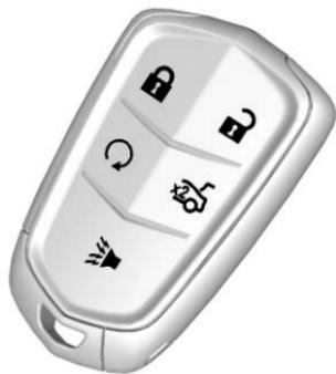
**🔒 (Blocco)** : Premere per bloccare tutte le portiere. Gli indicatori di direzione possono lampeggiare e/o l'avvisatore acustico può suonare per indicare il bloccaggio. Vedere *Personalizzazione del veicolo* ⇨ 167.
