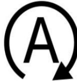
La spia si accende quando il motore è in un arresto automatico.
