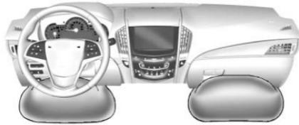
L'airbag per le ginocchia del conducente è dietro al piantone dello sterzo. L'airbag per le ginocchia del passeggero esterno è sotto il cassettino portaoggetti.
