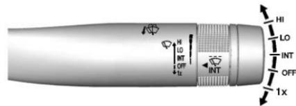
Con l'accensione del veicolo in posizione ACC/ACCESSORY o ON/RUN/STRT, spostare la leva per selezionare la velocità del tergilavacrystalli.
