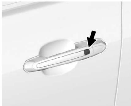
Usare il sistema di accesso senza chiave per bloccare e sbloccare la portiera. Quando le portiere sono bloccate e il telecomando del sistema di accesso senza chiave (RKE) si trova a una distanza massima di 1 m (3 piedi) dalla maniglia della portiera del conducente, premere il pulsante di blocco/sblocco. Quando lo sblocco avviene dalla portiera del conducente, la prima pressione sblocca quella portiera; premere di nuovo entro cinque secondi per sbloccare tutte le portiere dei
