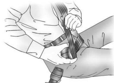
Se la cintura si blocca nella linguetta di chiusura prima di raggiungere la fibbia, oscillare la linguetta in modo che sia dritta per sbloccare la cintura.
