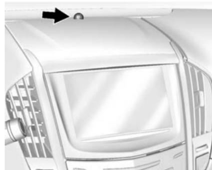
Un sensore di luce è ubicato sulla parte superiore del quadro strumenti. Non coprire il sensore. Altrimenti i fari si accenderanno quando non necessario.
