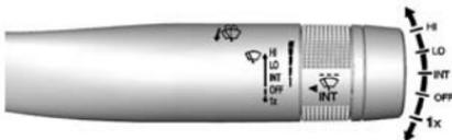
Con l'accensione del veicolo in posizione ACC/ACCESSORY o ON/RUN/STRT, spostare la leva per selezionare la velocità del tergilavacristalli.
