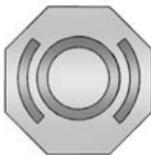
Sul tappo del serbatoio del liquido dei freni/frizione idraulica è sempre presente un simbolo o un testo che specifica il tipo di liquido dei freni da utilizzare. Il serbatoio dell'olio dei freni/frizione comune è riempito di liquido dei freni DOT 3 approvato da
