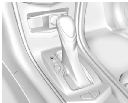
**P (parcheggio):** Questa posizione blocca le ruote posteriori. Utilizzare questa posizione quando si avvia il motore in quanto il veicolo non è in grado di muoversi agevolmente.
