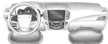
L'airbag per le ginocchia del conducente è dietro al piantone dello sterzo. L'airbag per le ginocchia del passeggero esterno è sotto il cassettino portaoggetti.
