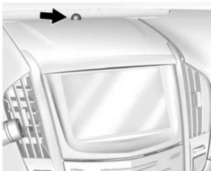
Il sensore solare controlla il calore solare.
