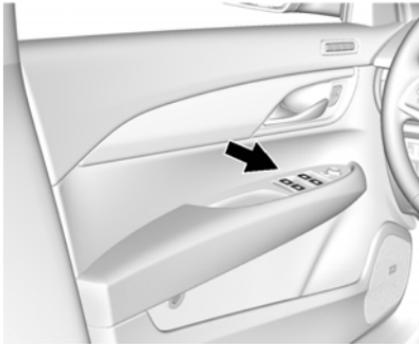
Gli alzacristalli elettrici funzionano solo con l'accensione in ACC/ACCESSORY o ON/RUN/START, o quando il Mantenimento dell'alimentazione per gli accessori (RAP) è attivo. Vedere *Mantenimento della corrente per gli accessori (RAP)* a pagina 9-22.
