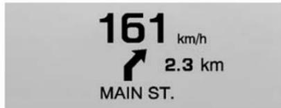
**Vista navigazione:** Questo display comprende le informazioni della vista velocità insieme con le informazioni di navigazione passo-passo. Quando l'itinerario di navigazione non è attivo è visualizzata la bussola.
