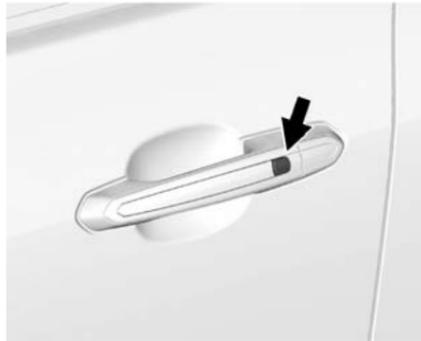
Se presente, usare il sistema di accesso senza chiave per bloccare e sbloccare la portiera. Quando le portiere sono bloccate e il telecomando del sistema di accesso senza chiave (RKE) si trova a una distanza massima di 1 m (3 piedi) dalla maniglia della portiera del conducente, premere il pulsante di blocco/sblocco. Quando lo sblocco avviene dalla portiera del conducente, la prima pressione sblocca quella portiera; premere di nuovo entro cinque secondi per
