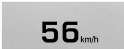
**Vista velocità:** Questo display mostra la lettura del tachimetro (in unità inglesi o metriche), la memoria dei segnali stradali, la velocità del cruise control adattivo, lo stato di allarme collisione anteriore,
