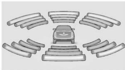
Il veicolo potrebbe disporre di display del sistema di ausilio al parcheggio sul cruscotto dotato di barre che mostrano la "distanza dall'oggetto" e le informazioni relative alla posizione dell'oggetto per l'URPA e, su alcuni veicoli, per il sistema di ausilio al parcheggio anteriore. Più l'oggetto si avvicina
