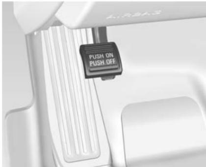
Per azionare il freno di stazionamento premere il pedale del freno normale, poi premere il freno di stazionamento.
